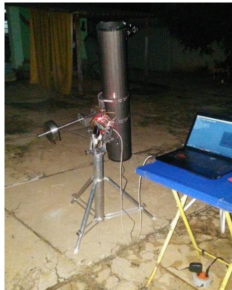
Figura 10. A montagem equatorial do projeto com um telescópio newtoniano rastreamento estrela próxima ao meridiano durante procedimento de alinhamento polar por declinação (Lemes, 2018).
